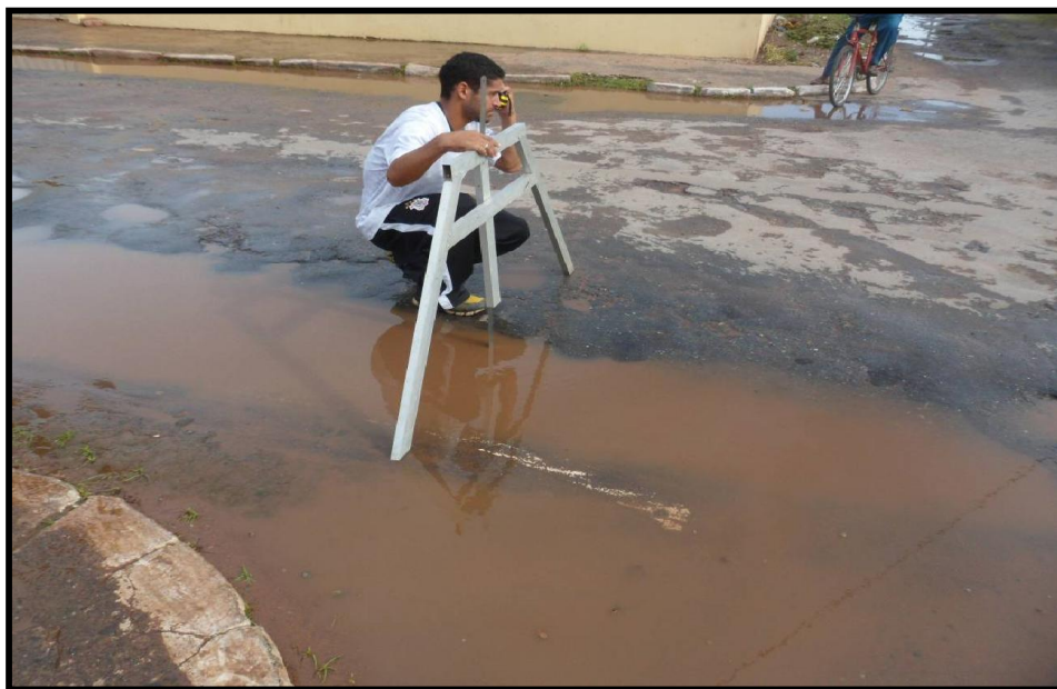
Foto - 15: Levantamento cadastral com trelça para identificação de afundamento em trilhas de rodas.
